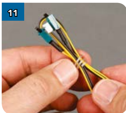
11 Разверните и аккуратно расправьте провода предельных выключателей.
