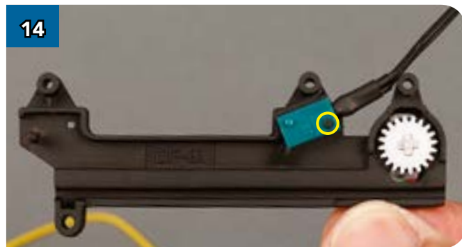
14 Установите выключатель так, чтобы штифт детали (DF-81) вошёл в его отверстие.
