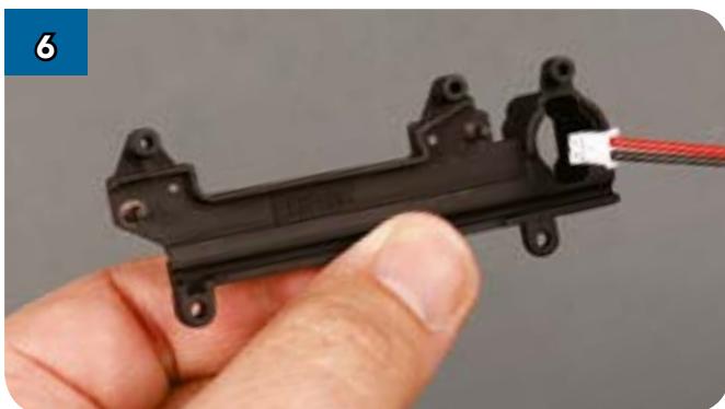
6 Проденьте провода в отверстие детали (DF-81).
