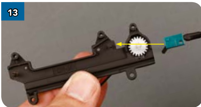
13 Поднесите выключатель с чёрными проводами к детали (DF-81) так, как показано на фотографии.
