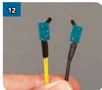
12 К одному выключателю подсоединены жёлтые провода, а к другому — чёрные.
