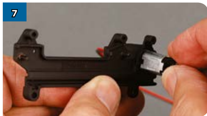
7 Вставьте в это же отверстие двигатель (он входит только в одном положении).
