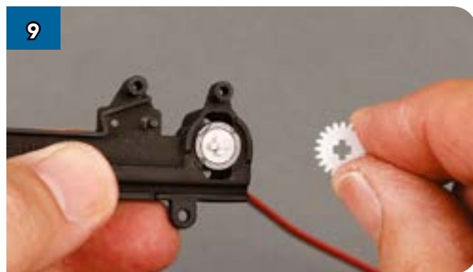
9 Наденьте шестерёнку на вал двигателя.
